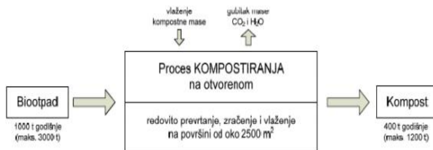
Slika 7: Tehnološka shema procesa kompostiranja
